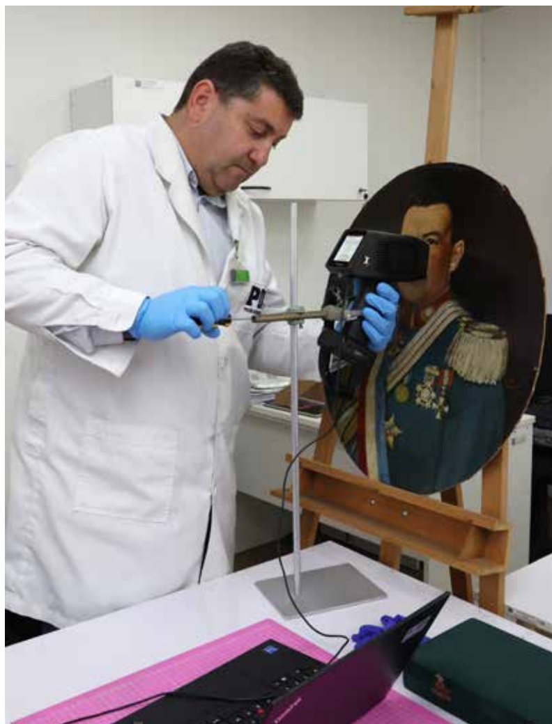
Análisis Espectrometría de Rayos X, Laboratorio de Restauración MHC. La prueba fue realizada por Alejandro Cortés. Profesional Perito LACRIM. Imagen: Sección Fotografía LACRIM Central PDI, 2025.
